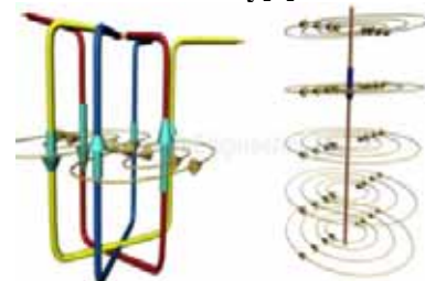
Gambar 2 Arus pada Kabel menghasilkan Fluks [2]
